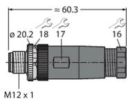
Connecteur mâle confectionnable, M12 × 1, droit, 8 pôles, raccordement par borne à vis, diamètre de ligne 6,0 à 8,0 mm, section conducteur/section raccordable 0,14 à 0,50 mm<sup>2</sup>, boîtier plastique, vis de montage métallique
