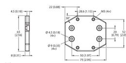
Adapterplatte zur Montage des QR20 Gehäuses mit Befestigungsbohrungen für das Q20L60 Gehäuse
