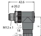
现场可接线公头接插件, M12 x 1, 弯角型, 8针, 螺旋式接线柱连接, 电缆穿墙护孔6.0至8.0 mm, 线芯横截面/接线柱可容面积0.14至0.50 mm<sup>2</sup>, 塑料外壳, 金属固定螺钉
