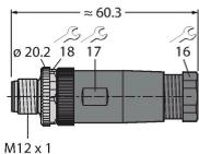
现场可接线公头连接器, M12 x 1, 直型, 8针, 螺旋式接线柱连接, 电缆穿墙护孔6.0至8.0 mm, 线芯横截面/接线柱可容面积0.14至0.50 mm<sup>2</sup>, 塑料外壳, 金属固定螺钉
