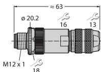
现场可接线公头连接器, M12 x 1, 直型, 8针, 螺钉接线柱连接, 电缆引线6.0-8.0 mm, 线芯横截面/终端容量0.14-0.50 mm<sup>2</sup>, 塑料外壳, 金属螺母, 可屏蔽, 还用于以太网
